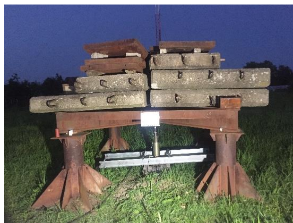
Figura 4.10. Presă hidraulică pentru aplicarea încărcării statice a); Lest pentru executarea încercării de încărcare static b)
