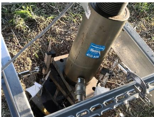
Figura 4.10. Presă hidraulică pentru aplicarea încărcării statice a); Lest pentru executarea încercării de încărcare static b)
